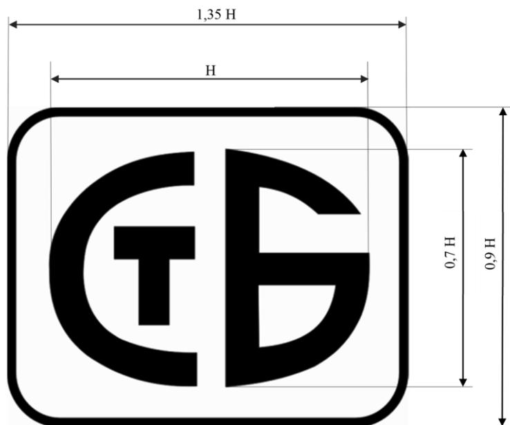
Размеры знака соответствия определяются путем выбора базового размера Н.
