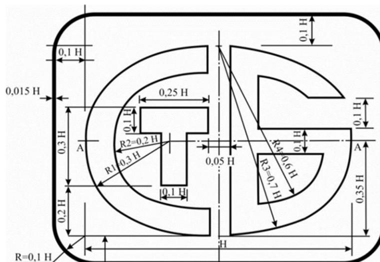
Размеры букв "С", "Б" и "Т", а также рамки со скругленными углами определяются путем выбора базового размера Н.
